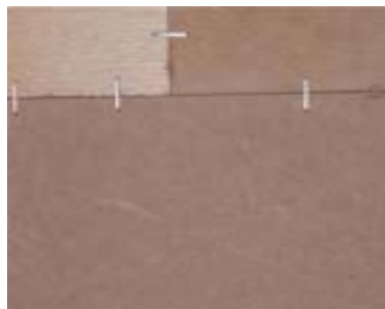
Fotos. 8 e 9. Confeção de mosaico de restos de MDF, para formar Chapa crua. Observe-se o detalhe da costura, com grampas metálicos.
