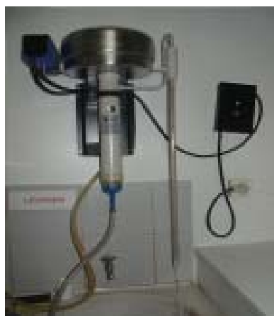
Foto1. Destilador de água, mostrando a perda de água de resfriamento.
