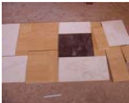
Fotos. 8 e 9. Confeção de mosaico de restos de MDF, para formar Chapa crua. Observe-se o detalhe da costura, com grampas metálicos.
