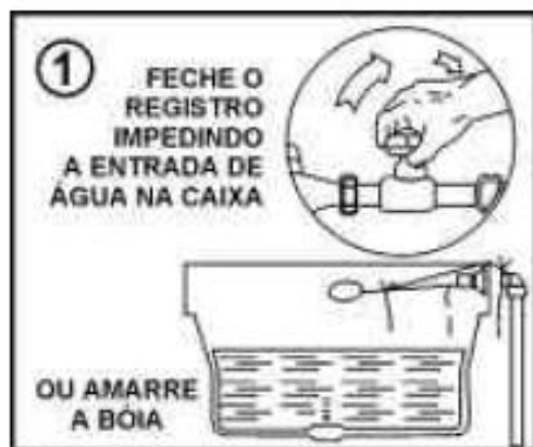
Figura 62 - Instruções para Limpeza e Desinfecção da Caixa d'água
