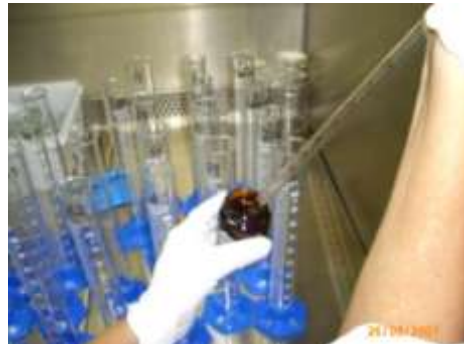
Dosagem amostra com pipeta
