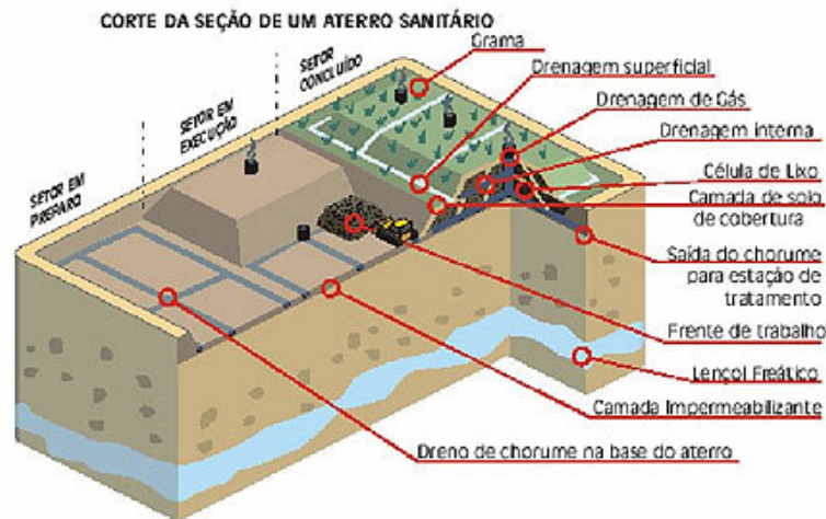
Figura 13 – Aspectos Construtivos de um Aterro
